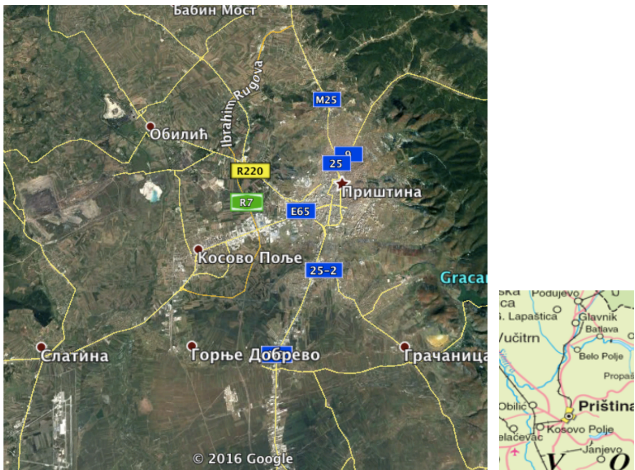
Slika 130: Auto-put je označen narandžastom bojom ( 7 i R220), žuto su magistralni i regionalni putevi, aerodrom je u donjem levom uglu, a železnička pruga se ne vidi jasno na levoj slici, te je prikazana desno, crnom linijom sa poprečnim crticama - čvorište u Kosovom Polju – pravac sever-jug Beograd-Skoplje od koga se odvaja pravac kroz Prištinu za Kuršumliju ka istoku i za Peć ka zapadu.
